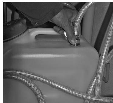
2. Rücklaufschlauch befestigen
