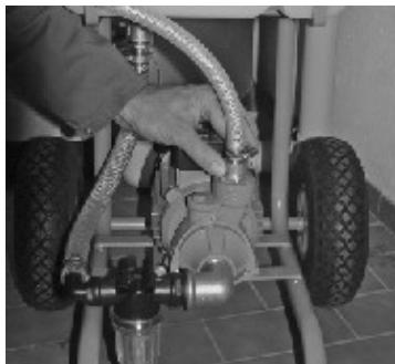
1. Druckschlauch am Pumpenausgang anschließen
