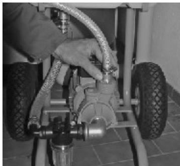
1. Raccorder la conduite souple au refoulement de la pompe.
